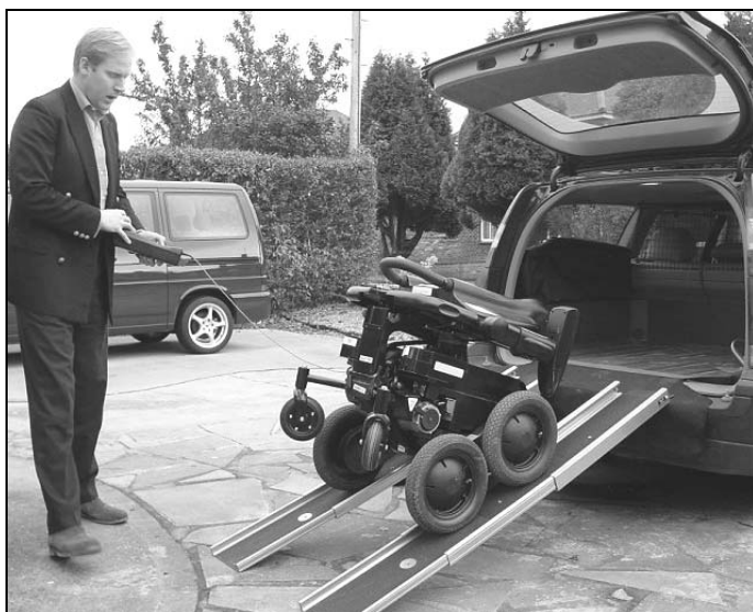
Рис. 1.66. Раздельная погрузка ассистентом инвалида и ТСР, когда ТСР погружают по аппарелям сзади серийного автомобиля в дистанционном (по кабелю) режиме с использованием ручного пульта управления [63]
