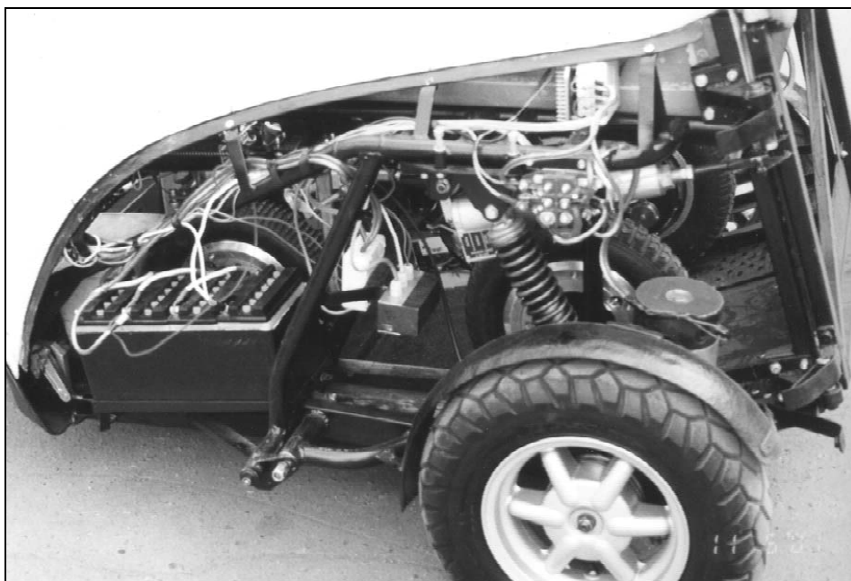
Рис. 1. 98. Устройство мотоносителя: виды справа-сзади (А); слева-сзади (Б); слева (В) при снятых крыльях и открытой двери
