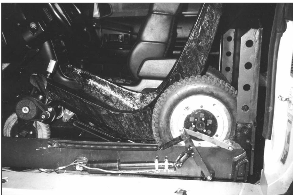
Рис. 1.79. Ходовой макет транспортного комплекса «О» на базе автомобиля «Oldsmobile», транспортное положение при открытой дверце
