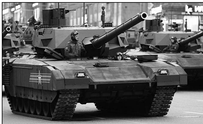
Рис. 1.45. Российский серийный танк Т14 «Армата» с бронированной капсулой переднего (носового) расположения на трех членов экипажа, внешний вид [23]
