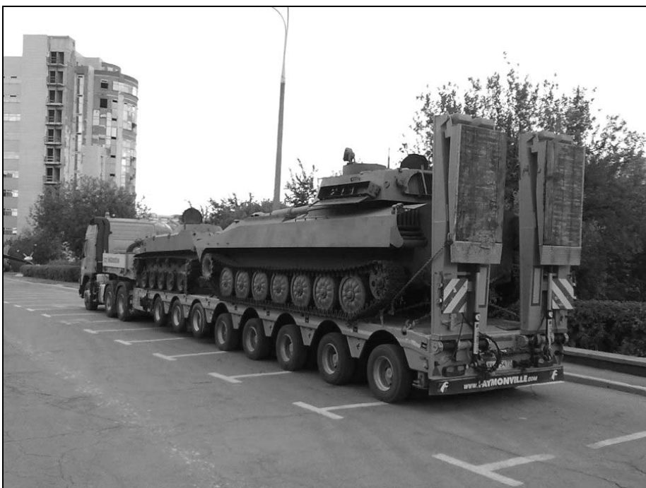
Рис. 1.111. Трейлерная перевозка двух объектов бронетехники [86]
