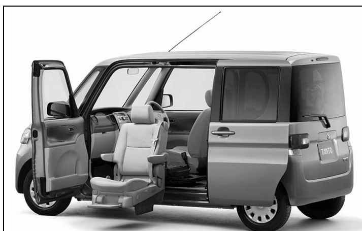
Рис. 1.68. Специализированный автомобиль-фургон с выдвигаемым наружу водительским сиденьем для посадки инвалида за руль [67]
