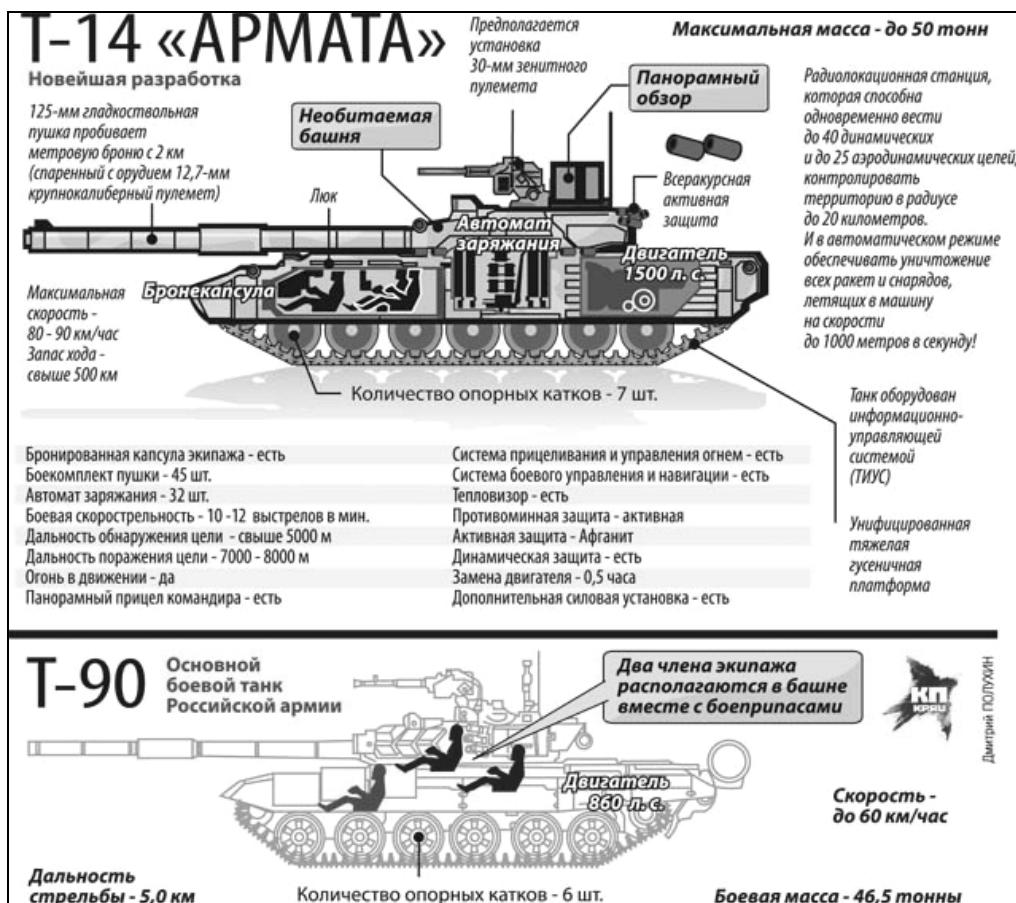
Рис. 1.46. Российский серийный танк Т14 «Армата» с бронированной капсулой переднего (носового) расположения на трех членов экипажа, сравнительные ТТХ и компоновка [23]
