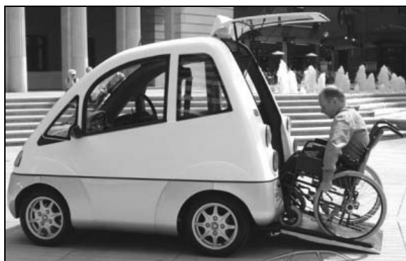
Рис. 1.82. Совместная самостоятельная погрузка инвалида и ТСР сзади по аппаратам в относительно большой салон специального автомобиля Quovis компании Vexel (Испания) [74]
