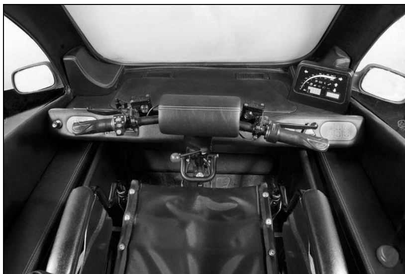
Рис. 1.83 (окончание). Мини-автомобиль «Кенгуру»: Д, Е – место инвалида пользователя за рулем мотоциклетного типа [75]
