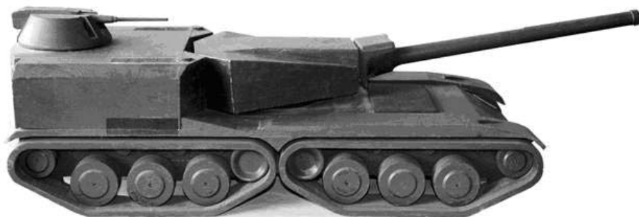
Рис. 1.10.. Деревянная модель первого варианта новой компоновки танка «Объект 490». 1:10. (в первоначальном варианте гусеничные движители предполагались в обводах 3+3 катка) [13]
