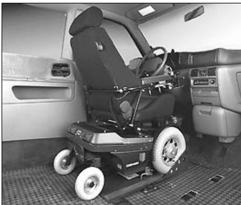
Рис. 1.69. Зарубежный транспортный комплекс «Пермобиль – микроавтобус» с размещением пермобиля с пользователем-инвалидом за рулем микроавтобуса [67]
